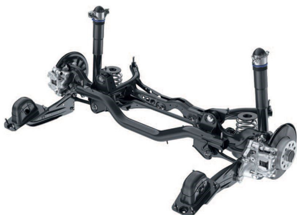
Abb. 1: Mehrlenker-Hinterachse Fig. 1: Multilink rear axle
