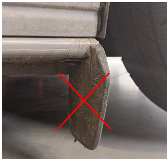
Abb. 6: VA Schmutzfänger demontieren Fig. 6: FA remove mud flap
