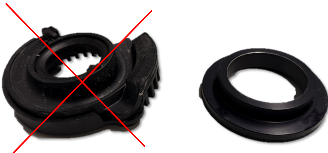
Abb. 3: HA untere Federaufnahme Fig. 3: RA lower spring mount
