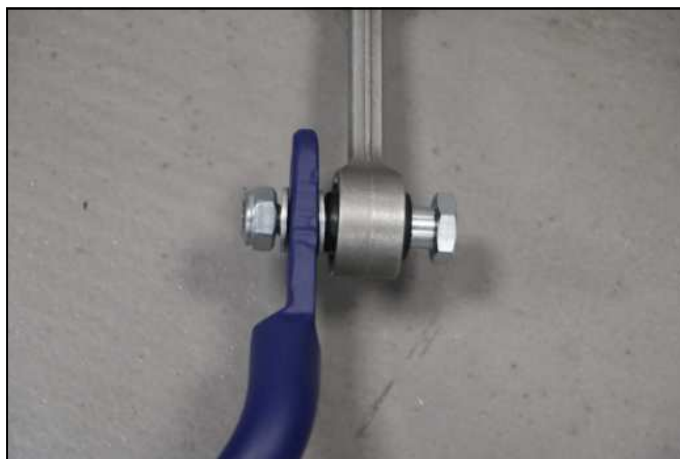
Abb. 2: Schraube mit ca. 50 Nm anziehen.
