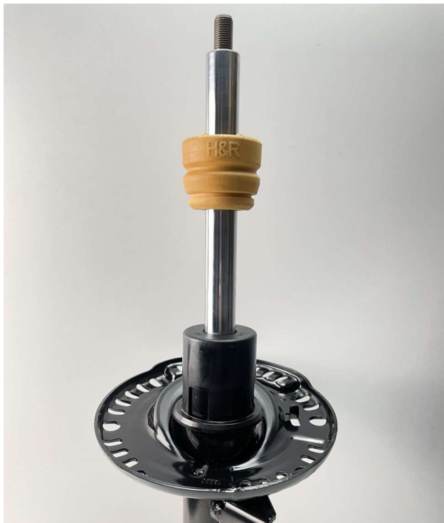
Abb. 1: H&R Anschlagpuffer montieren
