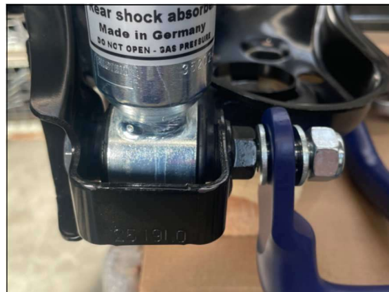
Abb. 2: Befestigung der Stabilisatorenenden
