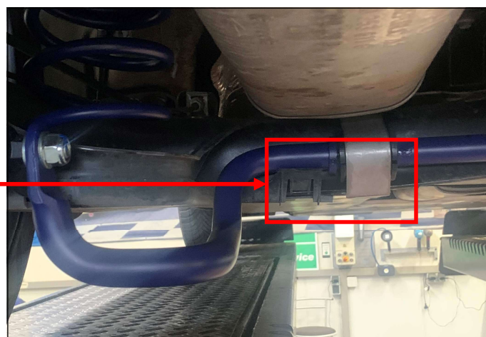
Abb. 5 & 6: Ausklinken des Steinschlagschutzes (fahrzeuginnere Klemmbefestigung wird entfernt)
