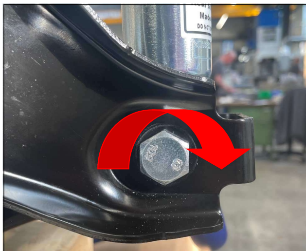
Abb. 10: Anziehen der HA-Stoßdämpferschraube Fig. 10: Fasten of RA shock absorber fixation
