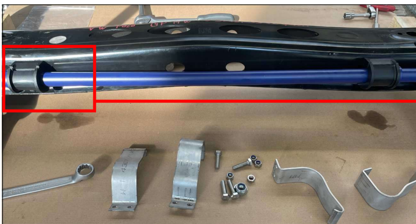
Abb. 3 & 4: Lagergummi Positionierung durch Stellringe
