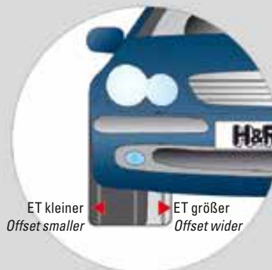
Spurverbreiterungen von 10-90 mm möglich Track increase available from 10-90 mm
