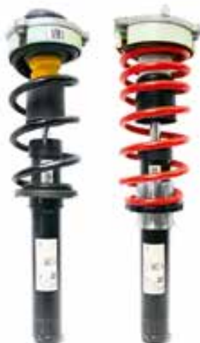
Bild Links: Original Federbein mit Serien-Feder Bild Rechts: Original Federbein mit H&R Gewindefeder
