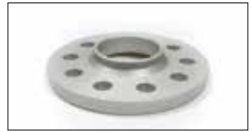
Artikel-Nr. / Part-no. 2445651: Radnabenlänge max. 15 mm. Felgeninnenfase mind. 5x45° Wheel hub length max. 15 mm. Inner bavel 5x45°
