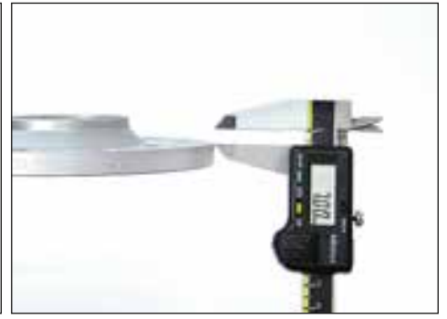
Darstellung Aussenfase 7x45° / Outer bevel 7x45°
