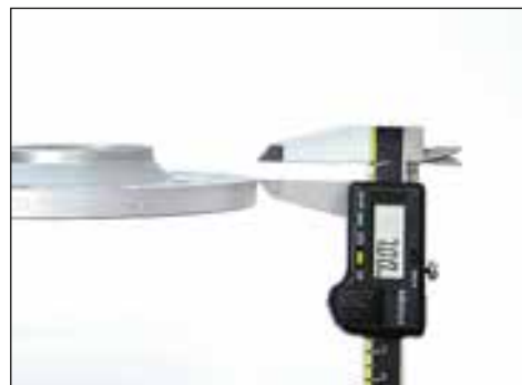
Darstellung Aussenfase 7x45° / Outer bevel 7x45°
