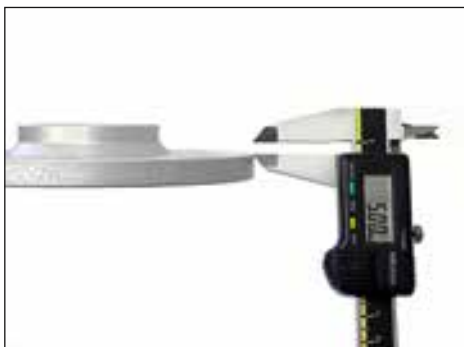
Darstellung Aussenfase 5x45° / Outer bevel 5x45°
